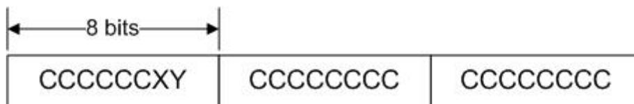
Figura 2.3 – Três primeiros octetos do identificador de *interface* IPv6.
