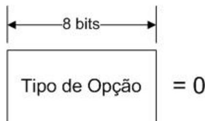
Figura 3.6 – Valor do tipo de opção *Pad1* de um pacote IPv6.
