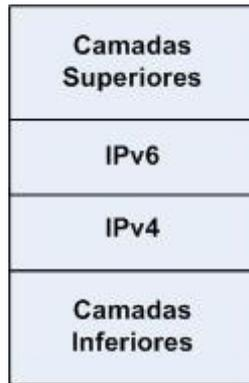
Figura 6.3 – Esquema da pilha TCP/IP num túnel.
