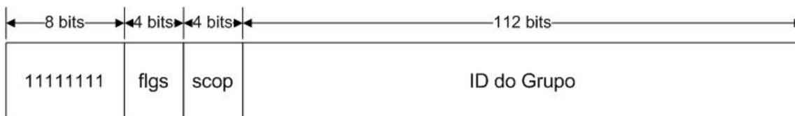
Figura 2.10 – Estrutura de um endereço IPv6 *Multicast*.
