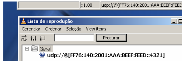
Figura 6.45 - Embedded RP, cenário nativo - Configurar o VLC para receber vídeo
