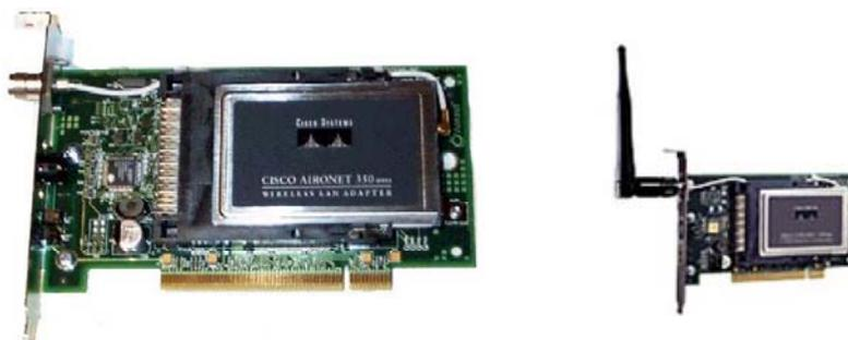
figura 20 - Placa PCI Cisco (AIR-PCI352).
