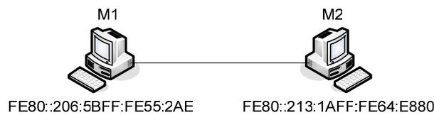
Figura 3.49 – Cenário utilizado para testar a resolução de endereços.
